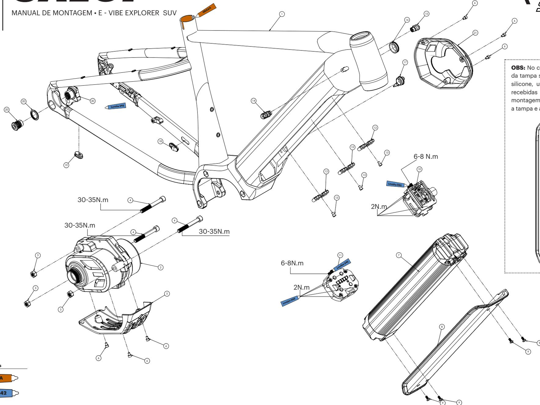
**OBS:** No caso do recebimento da tampa sem o espaçador de silicone, utilizar as 4 arruelas recebidas no kit da bike, a montagem deve ocorrer entre a tampa e a bateria.
