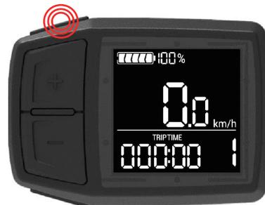
Pressione o botão **Liga/Desliga**, e, então, o display retornará conforme a **passo 5**.
